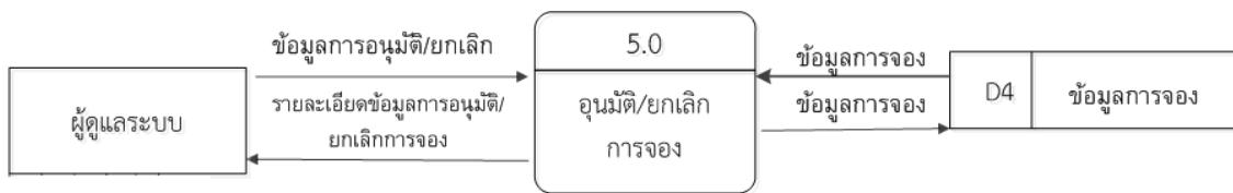
ภาพที่ 3-7 Data Flow Diagram Level 5 การอนุมัติและยกเลิกการจอง
