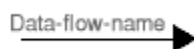
ภาพที่ 2-6 แสดงสัญลักษณ์แทนกระแสข้อมูลเป็นลูกศร
