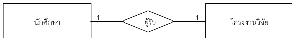
ภาพที่ 2-7 แสดงความสัมพันธ์แบบหนึ่งต่อหนึ่ง
