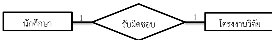
ภาพที่ 2-8 สัญลักษณ์ของ Relationships ความสัมพันธ์แบบหนึ่งต่อหนึ่ง
